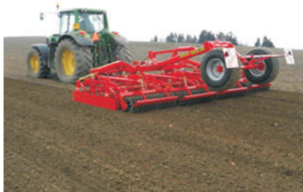
Fig. 20. Lucrarea solului cu combinatorul pentru pregătirea patului germinativ
