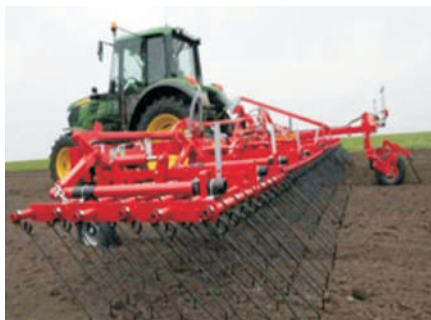
Fig. 35. Cultivarea oarbă cu o grapă flexibilă
