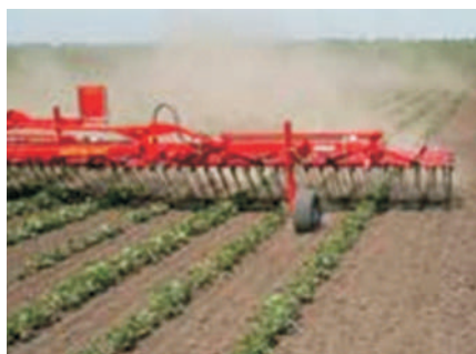
Fig. 38. Condiții optime: sol uscat și cușite curate
