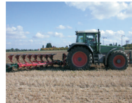
Fig. 19. Aratul solului cu plugul cu cormană și antetrușiță
