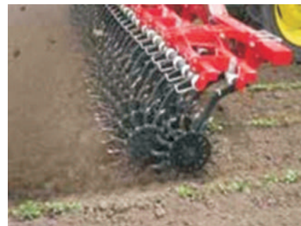
Fig. 39. Cultivatoare-prășitoare rotative, care pot opera cu viteze mari
